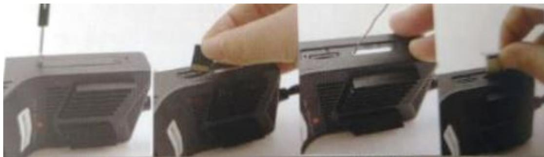
2.- conecte la antena GPS y el cable de alimentación al dispositivo
